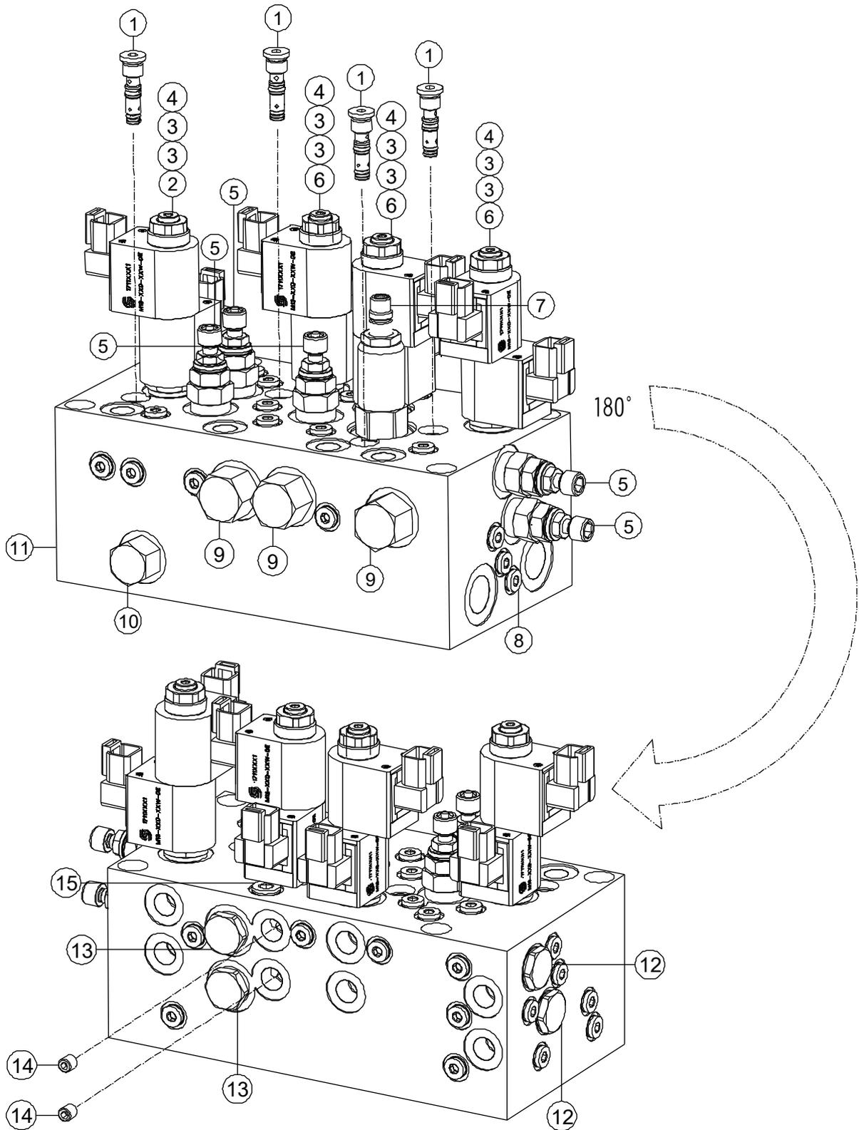
**3-31 Valve Block (BT30SRT, BT28SRT, BT26SRT)**
